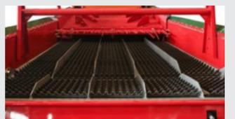
Gran sala de limpieza de 1000 mm y ventilador centrífugo de dos etapas ofrecen un área de limpieza grande y una alta eficiencia de limpieza. Tamiz vibratorio de doble capa y movimiento opuesto mantienen la limpieza y alta tasa de preservación.
