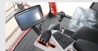
Adopta una operación de una sola palanca y control por botón, el panel de control está vinculado con el asiento para asegurar comodidad y conveniencia.
