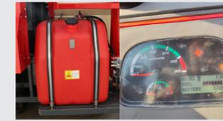
Tanque de combustible de 240L con sensor de alarma de aceite
