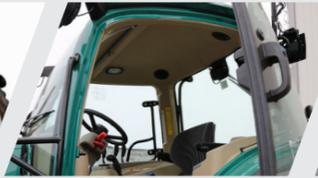
El vehículo cuenta con vidrio curvado panorámico de 360° y una cabina completamente cerrada con cuatro pilares y aire acondicionado, lo que proporciona un amplio campo de visión.
