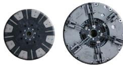
Serie Q usa embrague LUK de doble acción de control independiente de Alemania, que tiene calidad confiable y alta eficiencia de potencia transmisión y comodidad para controlar.
